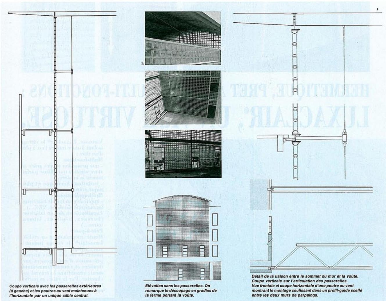
Coupe verticale avec les passerelles extérieures (à gauche) et les poutres au vent maintenues à l'horizontale par un unique câble central.
